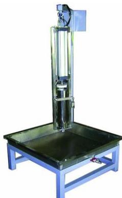
Gambar 5. mesin pencetak putu mayong hidraulik
